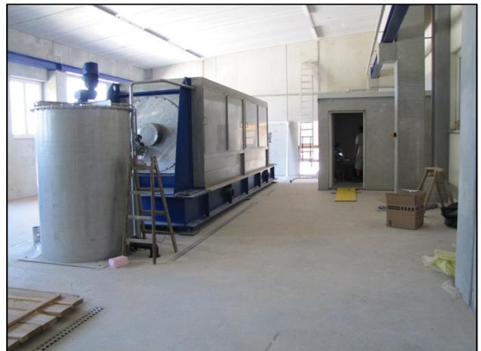
Bild 3: Schlamm Schneckenpresse
